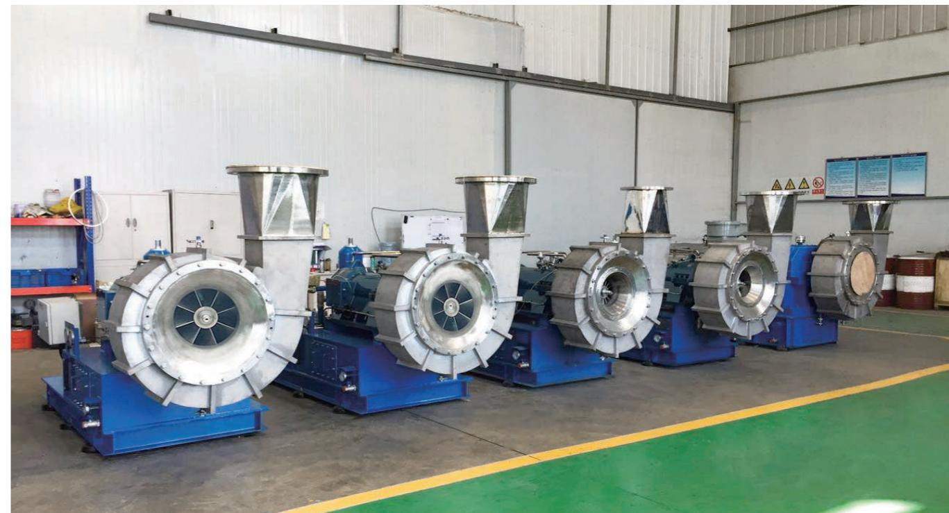
▼ 高速直驱离心蒸汽式压缩机
