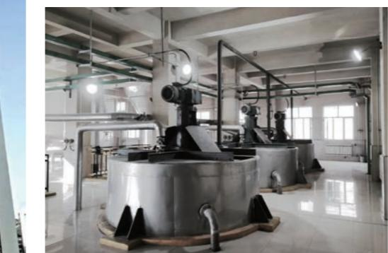
▼ 氯化钠废水蒸发结晶系统
